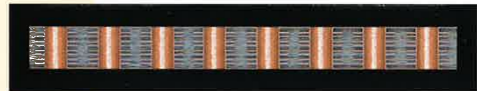
10層板スルーホールクロスセクション (貫通スルーホール) 10-layers through-hole cross-section (through-hole)
